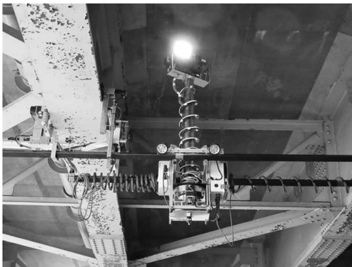
橋梁点検用ロボット
