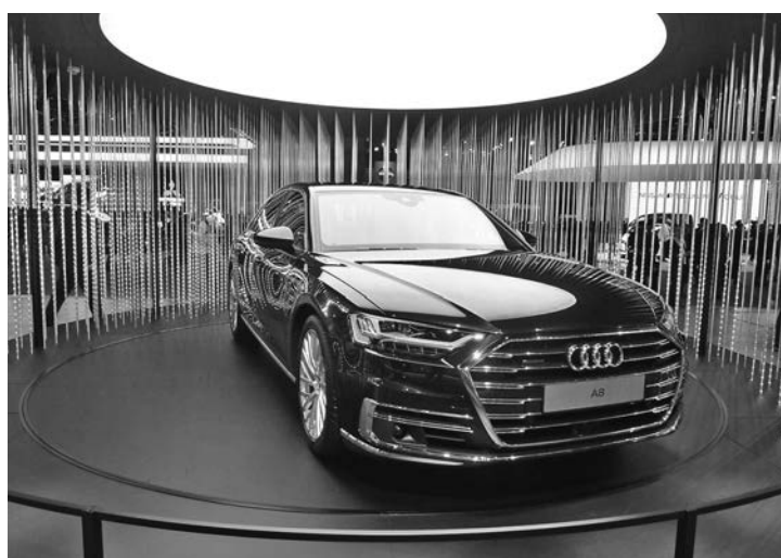
アウディの最新セダン「A8」：ナンバープレート下部にLiDARを搭載している
